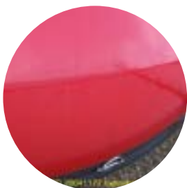
Lak beschadiging door verwijderen van reclame
