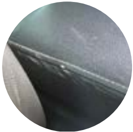
Scheuren en krassen in bekleding
