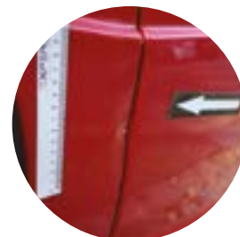
Carrosserie delen zoals laaddeuren en schuifdeuren met vervorming waarbij de lak is gekraakt en of verwijderd
